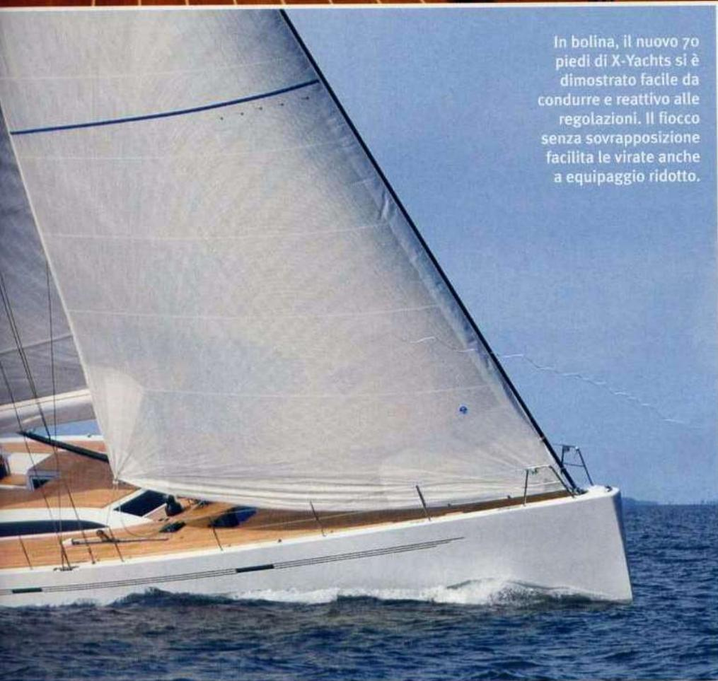
In bolina, il nuovo 70 piedi di X-Yachts si è dimostrato facile da condurre e reattivo alle regolazioni. Il fiocco senza sovrapposizione facilita le virate anche a equipaggio ridotto.
